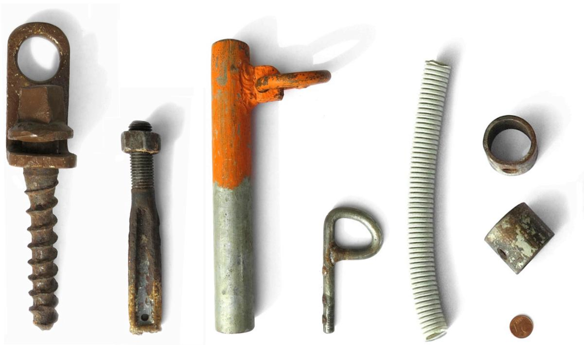
**Abb. 58** Verschiedene Objekte von F. Horich zum Einzementieren in Felslöchern
