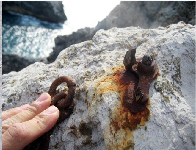
Abb. 65 Durchgerosteter Bohrhaken am Meer
