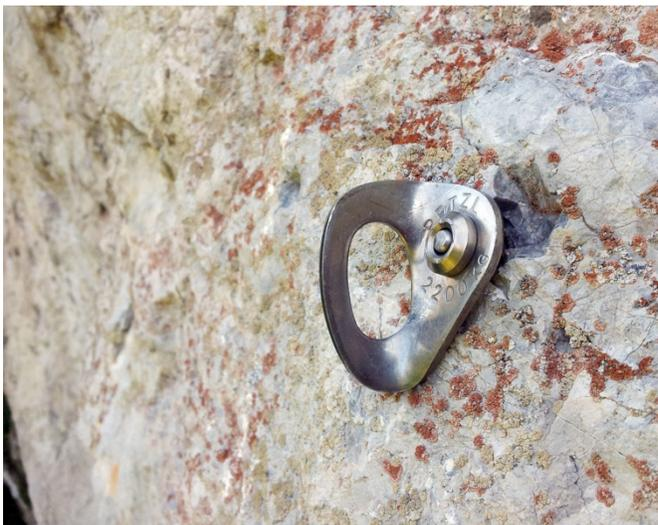
**Abb. 56 Felsausbruch bei einem Petzl Long-Life Bohrhaken**
