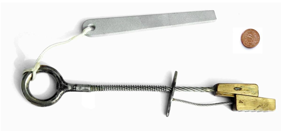
Abb. 43 Handgefertigter Messing-Slider
